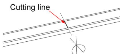
2. Wenn Sie den Streifen zuschneiden müssen, schneiden Sie ihn bitte entlang der Schnittlinie auf der Rückseite des Streifens.
