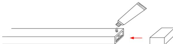
3. Die neu geschnittenen Enden müssen mit einer Endkappe und säurefreiem Silikon abgedichtet werden.
