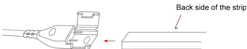
4. Führen Sie die Stifte des Stromkabels in das Kopfende des Streifens ein und stellen Sie sicher, dass die Stifte guten Kontakt mit den Kontaktflächen des Streifens haben. (Wenn das andere Ende des Streifens in die Stifte eingeführt wird, funktioniert der Streifen auch beim Einschalten nicht, falsche Polierung).
